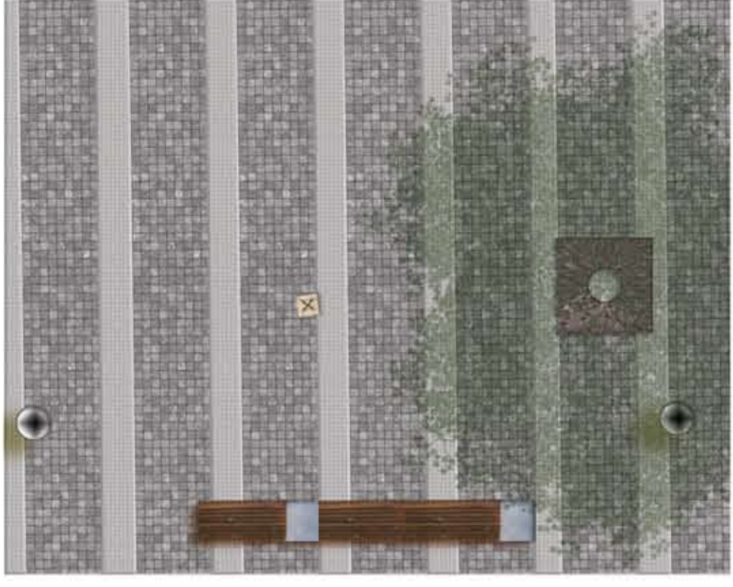
A Fő tér belső része fűrészelt andezit lapokkal burkolt, míg a gyalogos közlekedésre kijelölt sávok fűrészelt nagykockakő felülettel, kiskockakő raszterrel épülnek.
