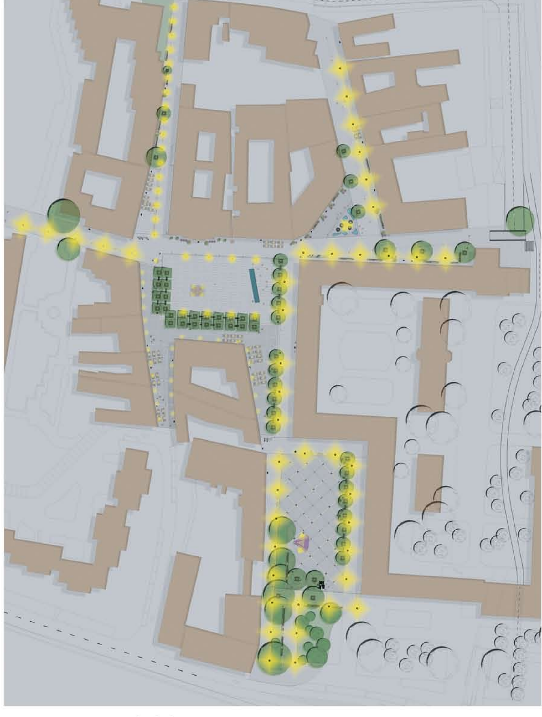
A Fő tér belső része fűrészelt andezit lapokkal burkolt, míg a gyalogos közlekedésre kijelölt sávok fűrészelt nagykockakő felülettel, kiskockakő raszterrel épülnek.
