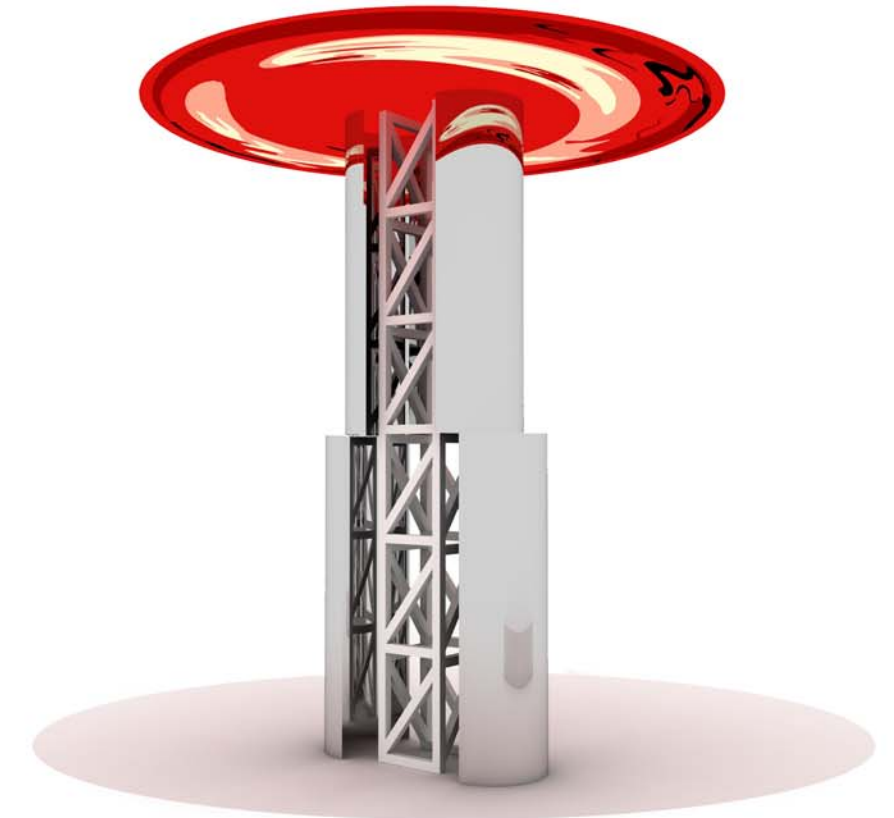
Ø600mm félkörszelvényű, elektropolírozású koracál burkolat
