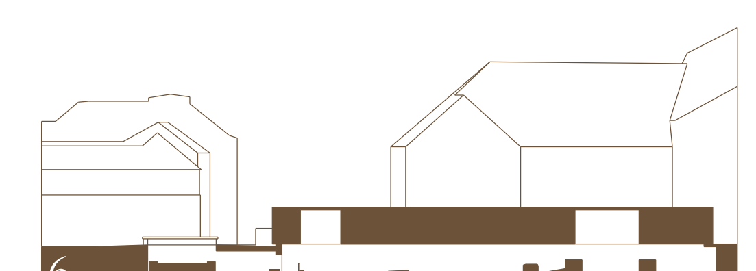
A védőtető struktúrája A közel 4 méter szerkezeti magasságú, 2,8 méter belmagasságú védőtetőben olyan nagy, kb. 6 méter belmagasságú térterek alakulnak ki, amelyek a bemutatott romterületnek megfelelően, 7 különböző helyen sajátosan „interferálnak” a romterülettel, segítve annak élményszerű, hangulatainak beazonosíthatóságát. Rom és strűt olyan új egységet hoznak létre, amely funkcionális célzatosságán túl egyszersmind látványosság, jelkép is tud lenni.
