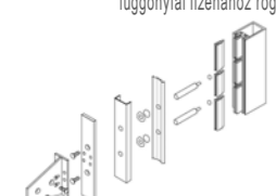
HOMLOKZATI RÖGZÍTŐELEM CSATLAKOZTATÁSA FÜGGÖNYFAL LIZÉNÁHOZ
