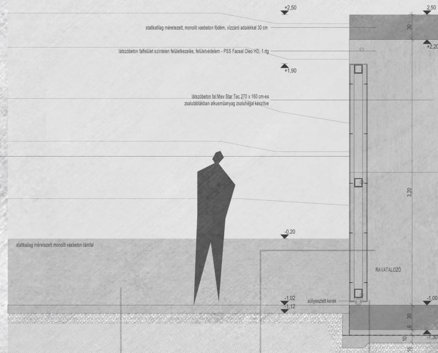
statikailag méretezett, monolit vasbeton földem, vízzáró adalékkal 30 cm
