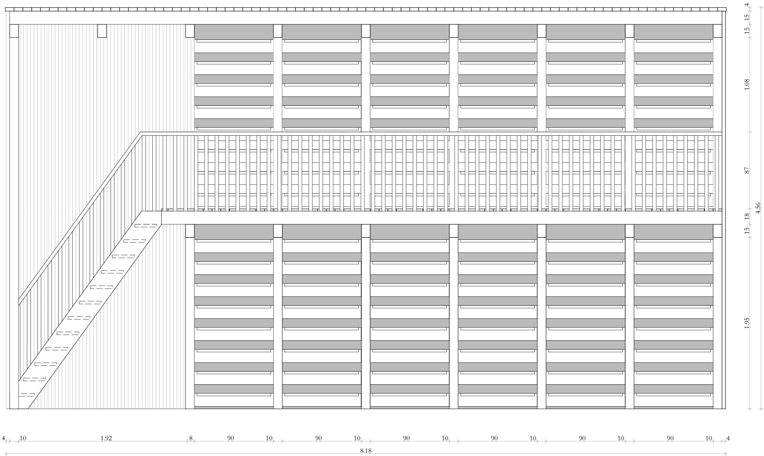
CSP8 - levendula szárító részletrajza m 1:10
