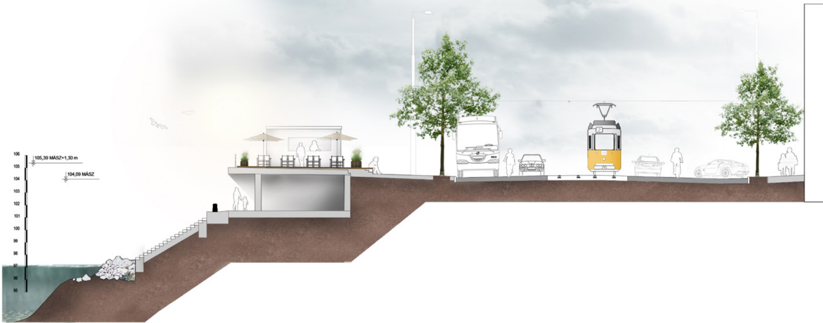
Belgrád rakpart természetse \ Cross-section of Belgrád Embankment
