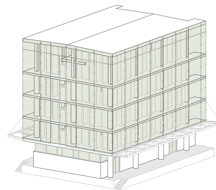
T4 ÜVEGBÚRA * üvegbordákra akasztható háromrétegű üvegezés * zárt lammellaálás esetén pufferzóna jön létre, melyből gépi légszivással a meleg elvezetődik * szolár 1m bevonat ~ napelem ablak, villamos energiát termel és hővisszaverő réteggént is funkcionál, csökkentve az épület túlmelegedésének veszélyét
