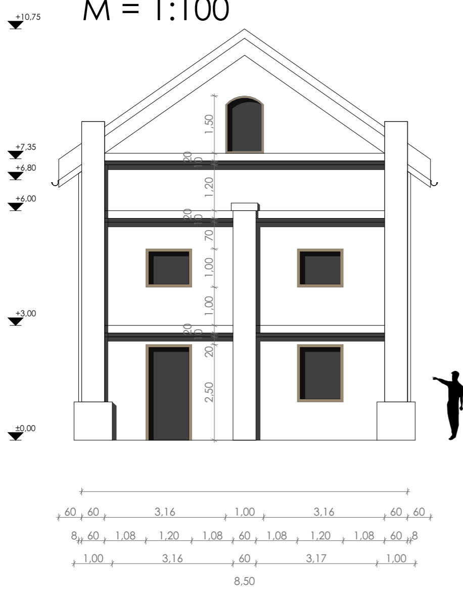
FELMÉRÉSI HOMLOKZAT (KELET) M = 1:100
