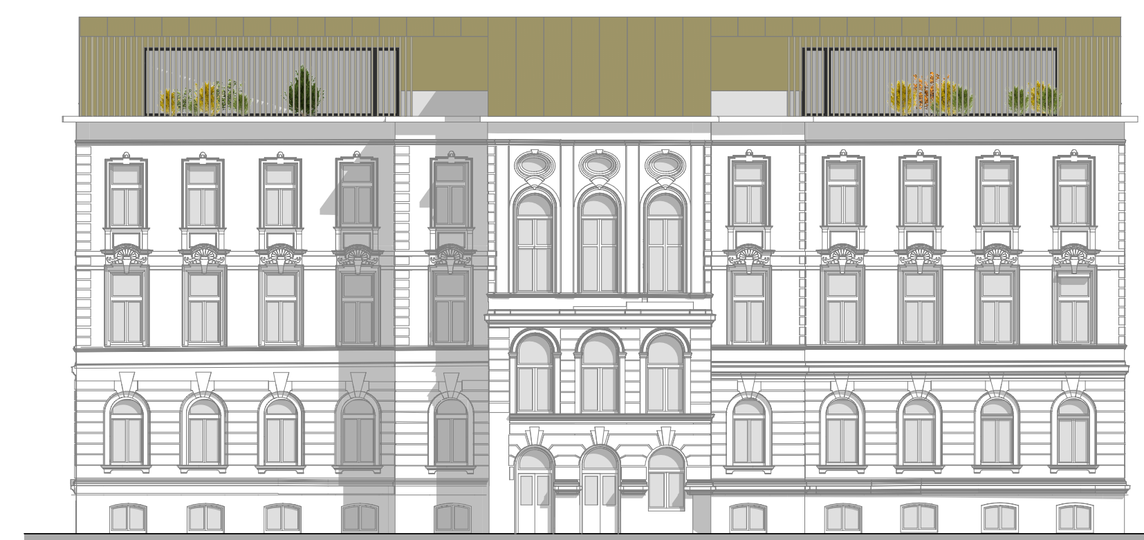
DÉLKELETI HOMLOKZAT M = 1 : 2 0 0
