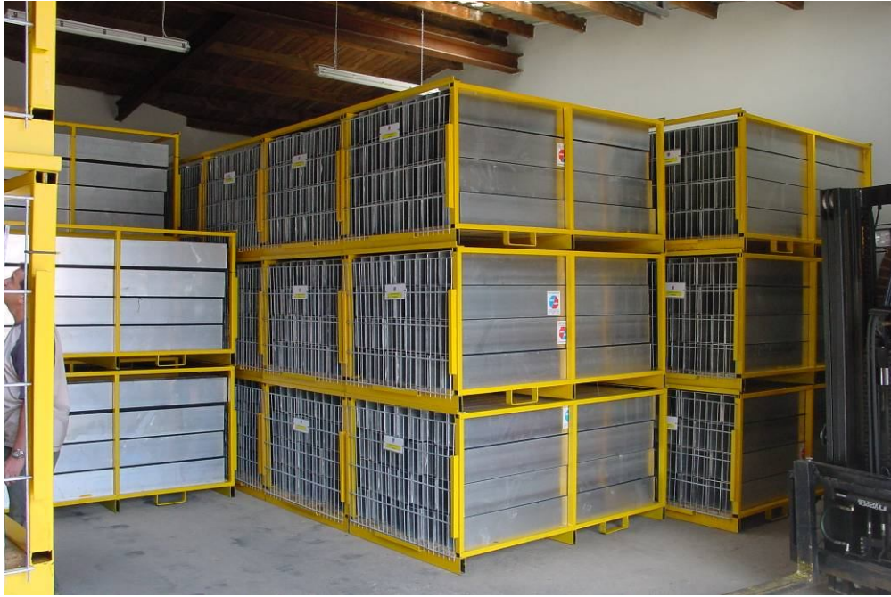
5. kép: Oszlopok közötti, betételes, fémszerkezetű mobilgát – árvízmentes időben
