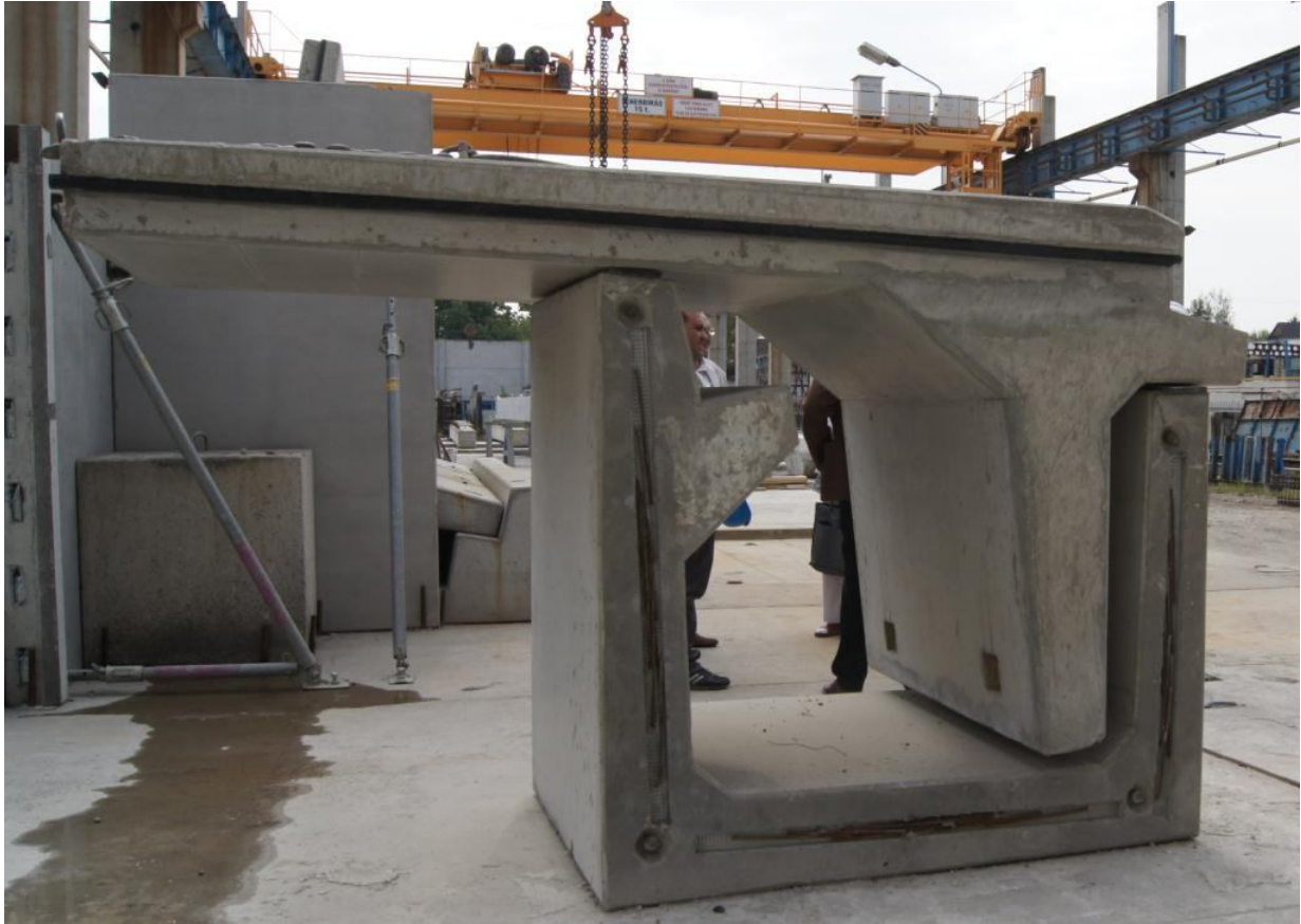
3. kép: Előre gyártott vasbeton-elemes mobilgát
