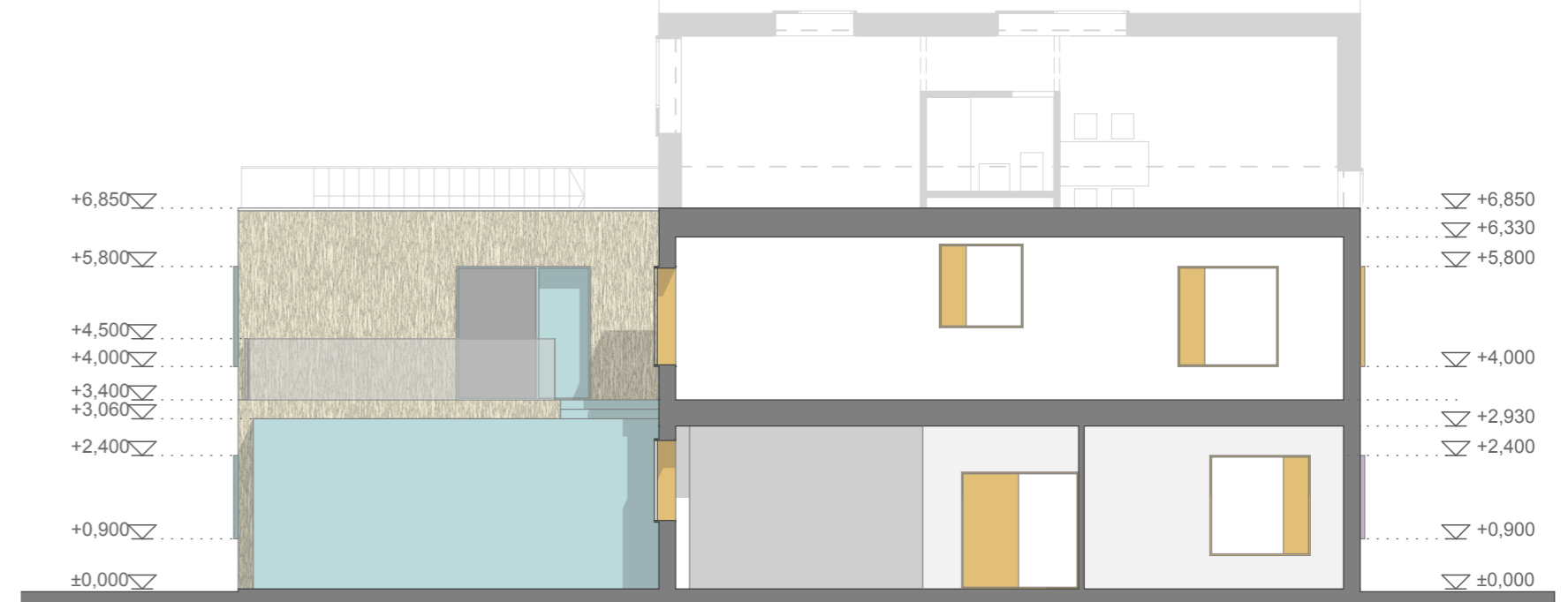
déli homlokzat - south facade m 1:125
