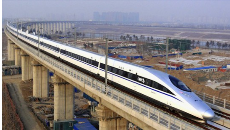
7. ábra: A kínai CRH380 típusú 16 részes motorvonat
