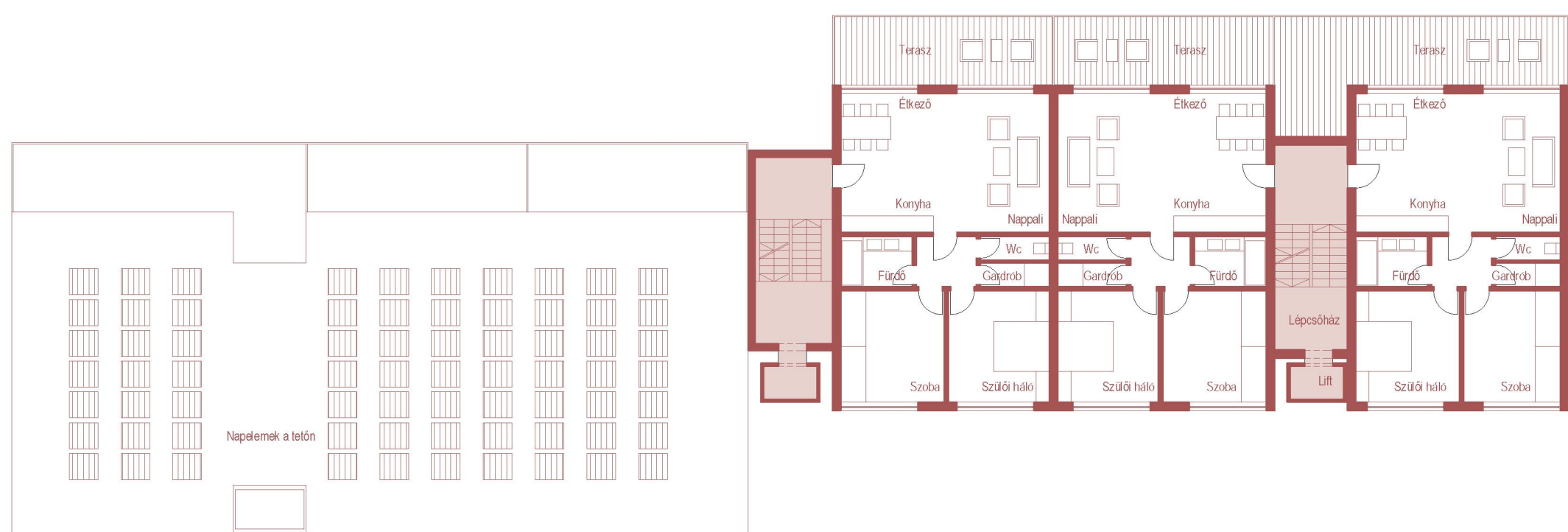
TETŐRÁÉPÍTÉS ALAPRAJZA 4 EMELETES HÁZTÍPUS M-1/200
