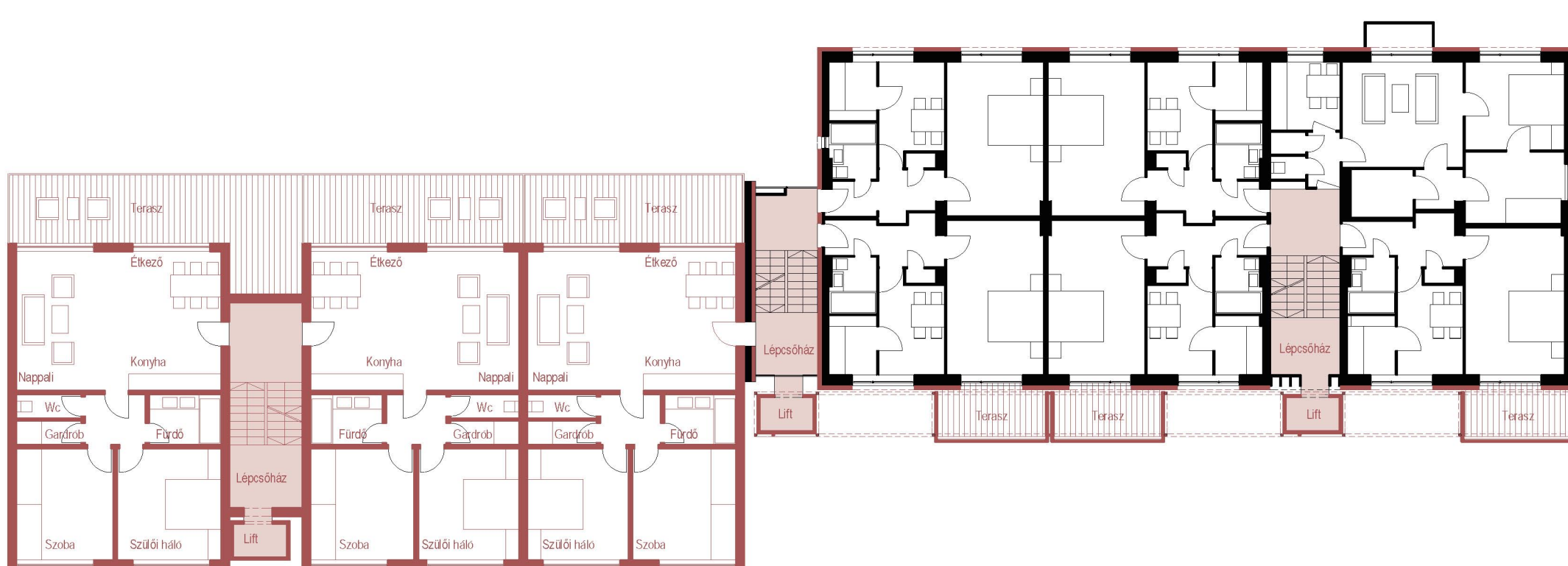
TETŐRÁÉPÍTÉS ALAPRAJZA 4 EMELETES HÁZTÍPUS M-1/200
