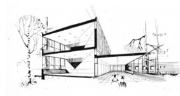
[5] Központi zsibongós rendszer axonometrikus metszete.
